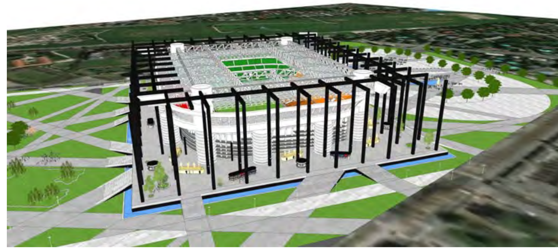
EREZIONE COLONNE PREFABBRICATE
